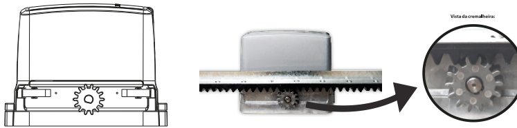
Figura 4: Vista do encaixe da coroa do automatizador deslizante na cremalheira pronto para uso.
